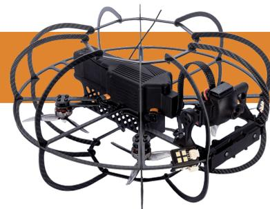
Le milieu industriel rime avec poussière. Une fois en suspension, décollée des surfaces par le mouvement des hélices, un nuage opaque peut rapidement se créer. Le système d'éclairage indirect du Stereo2 lui permet de récupérer une vision parfaite de l'environnement dans ces conditions et permet au pilote de compléter facilement son inspection.
